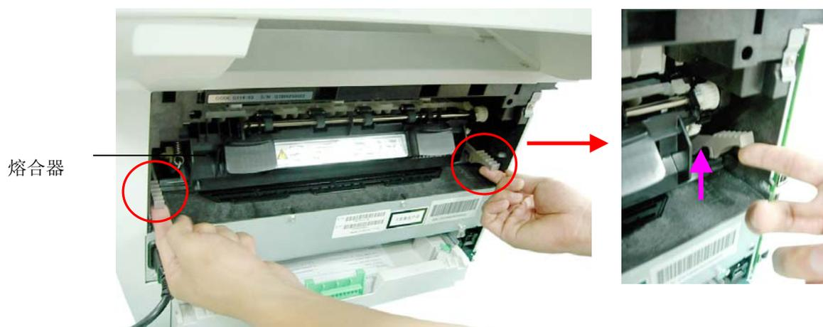
4. 依下图方法取出熔合器。
