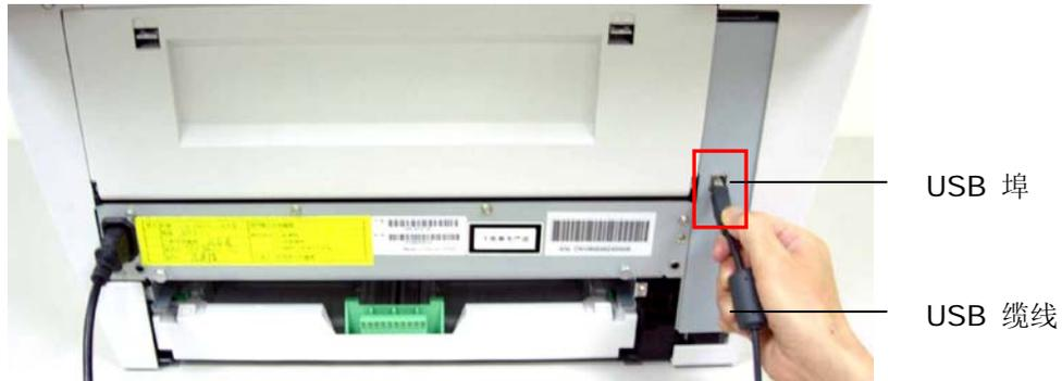
4. 因为本产品会包含两个USB装置，一个是扫描仪，另一个是打印机。计算机会出现两次「寻找新增硬件精灵」来辨识这两个USB装置。当下列「寻找新增硬件精灵」画面出现时，请按「**下一步**」并依照屏幕指示以完成安装。
